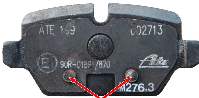
Odciski tłoczka hamulcowego na skutek nieprawidłowego montażu
