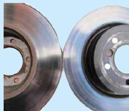
Po lewej: tarcza pokryta warstwą materiału ochronnego; po prawej: tarcza przegrzana
