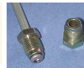
PRAWIDŁOWO UFORMOWANA KOŃCÓWKA PRZED JEJ ZAKLESCZENIEM W GWINTOWANEJ DWUZŁĄCZCE
